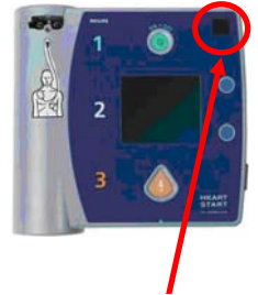
本体右上のステータス・インジケータ によって FR2+が使用可能かわかります
